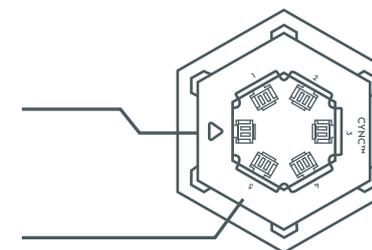
Les panneaux sont connectés en série. N'utilisez pas plus d'un port de sortie sur un panneau hexagonal.
